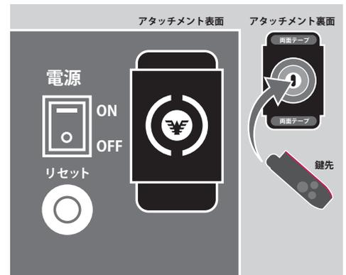
続いて鍵先の上から、本体アタッチメントを取り付けますが、両面テープで固定する前に手持ちキーで設定キーが回るかを確認してください。
