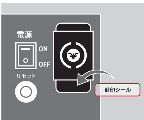
設定キーが回る事が確認できましたら本体・アタッチメントを両面テープでしっかりと固定し、最後に封印シールを貼って取り付け完了です。
